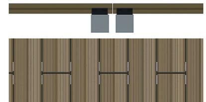
Chaque extrémité des planches doit être soutenue par un support. Là où 2 planches se succèdent dans la longueur, il faut donc placer 2 supports l'un à côté de l'autre.
